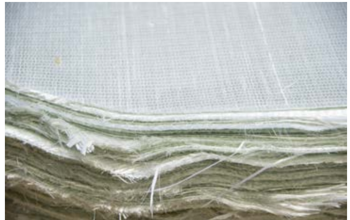
Tissu d'ingénierie utilisé pour produire des couvercles de regard en composite.
