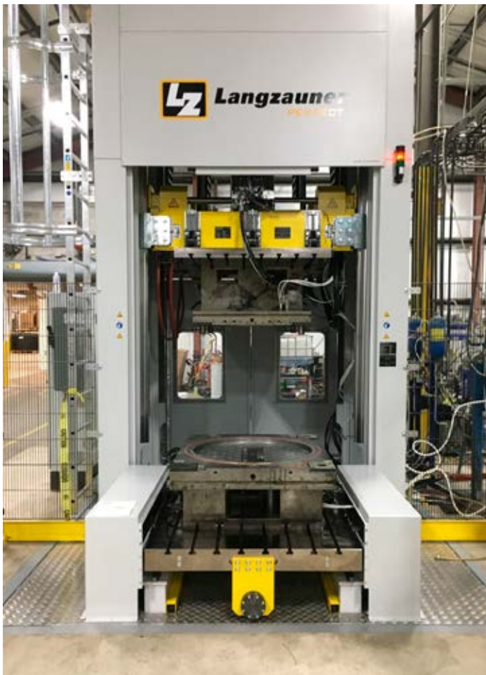
La presse hydraulique à haute pression est utilisée dans le processus de moulage par injection à réaction.
